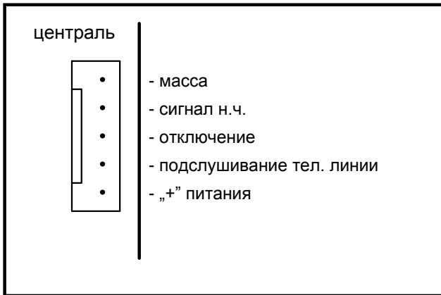
Рис. № 22. Распределение сигналов по разъемам синтезатора речевого оповещения SM-2.
